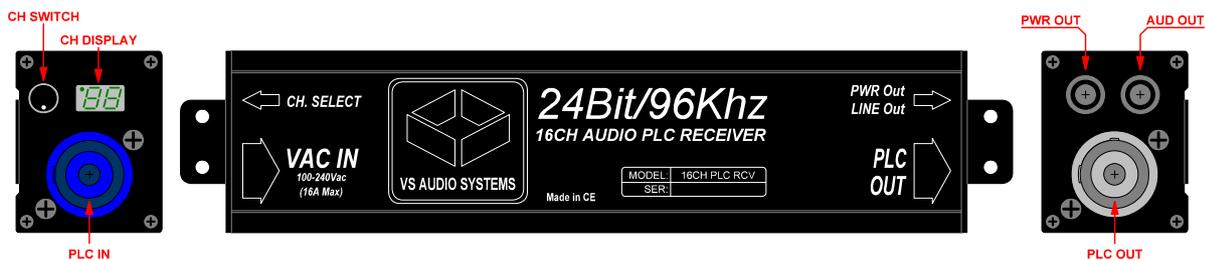
Unidad receptora portátil con un canal de salida de audio, seleccionable entre 16 mediante switch de 16 posiciones y display indicador digital del canal seleccionado.
